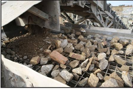
Módulo de criba horizontal de triple cama para el cribado antes de la trituración.
