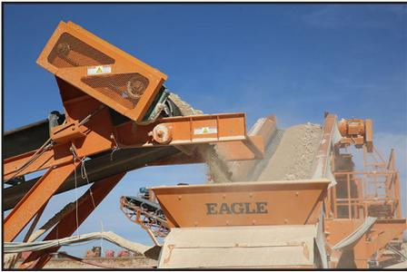
El transportador de alimentación de 45" permanece instalado para el transporte y elimina la necesidad de un transportador de alimentación separado.
