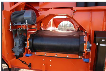
El transportador transversal reversible de 42" permite la alimentación en el transportador de apilamiento en ambos lados de la planta y cuenta con una cama de impacto de 5' y rodillos.
