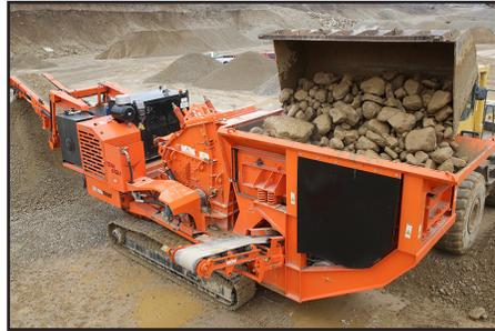
Tolva de alta resistencia dimensionada para alimentación con cargador o excavadora.
