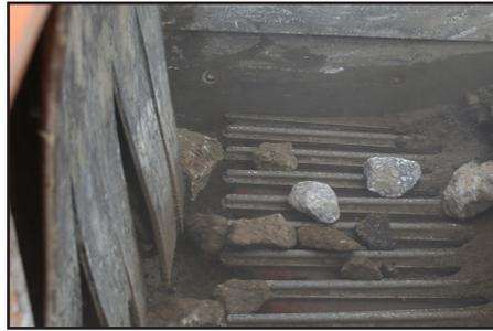
El conducto del grizzly con compuerta de flujo permite la remover el material que pasa por el grizzly a una banda transversal disponible para el apilamiento o mezclarlo con el material triturado.
