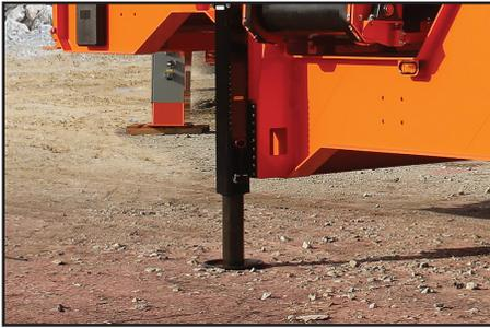
Sistema hidráulico de elevación y nivelación que permite una instalación y un desmantelamiento rápidos y fáciles.
