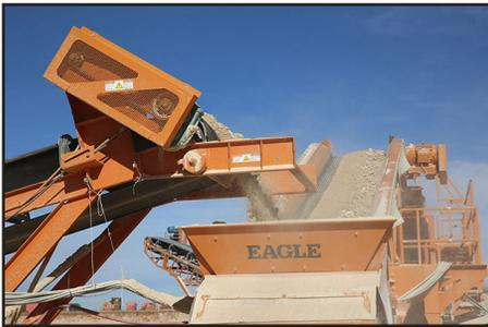
El transportador de alimentación integrado de 45" permanece sobre el chasis para transportarse, eliminando la necesidad de un transportador separado.
